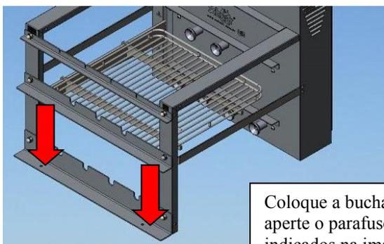
Coloque a bucha e em seguida aperte o parafuso nos dois locais indicados na imagem.
