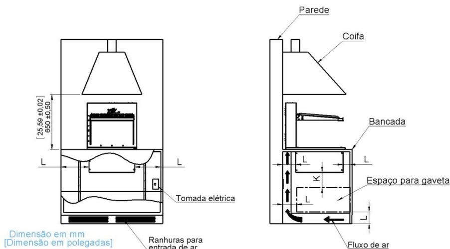
**Dimensões indicadas com “L” deverão ser de no mínimo 100 mm (3,94”) para facilitar a circulação do ar.**
