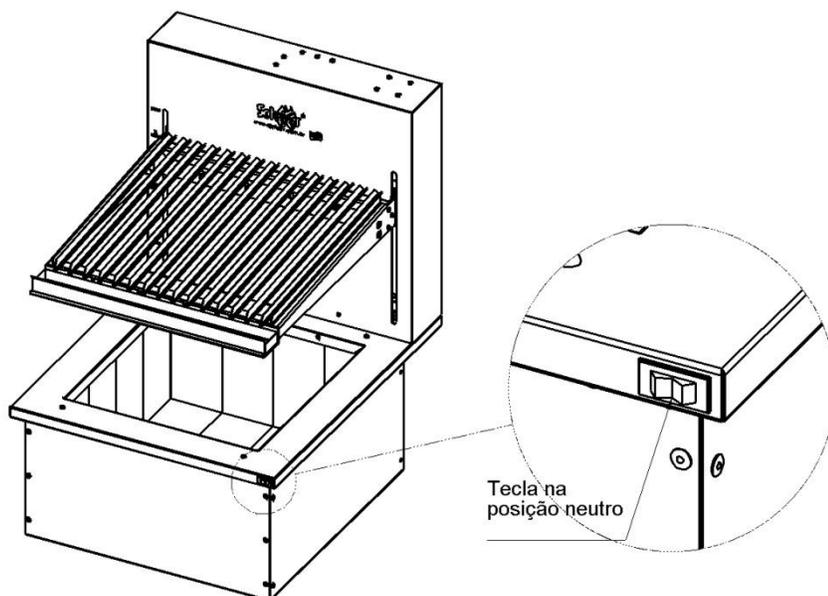
6.5. Após colocar o alimento na grelha, pressione a tecla sobe/desce para posicionar a grelha na altura desejada.
