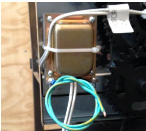
Para evitar riscos de choques elétricos, conecte o fio terra (fio verde ou verde/amarelo) deste produto a um sistema de aterramento, conforme norma brasileira NBR-5410.
