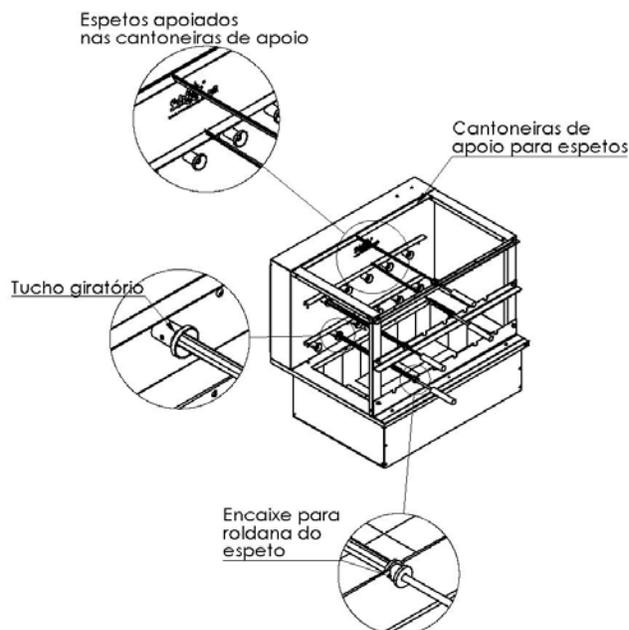
6.4. Após colocar o(s) espeto(s) na churrasqueira, pressione a tecla liga/desliga para acionar o sistema rotativo.
