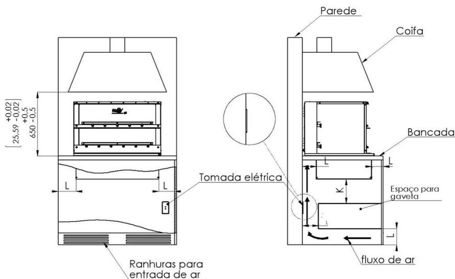
**Dimensões indicadas com “L” deverão ser de no mínimo 100 mm (3,94”) para facilitar a circulação do ar.**
